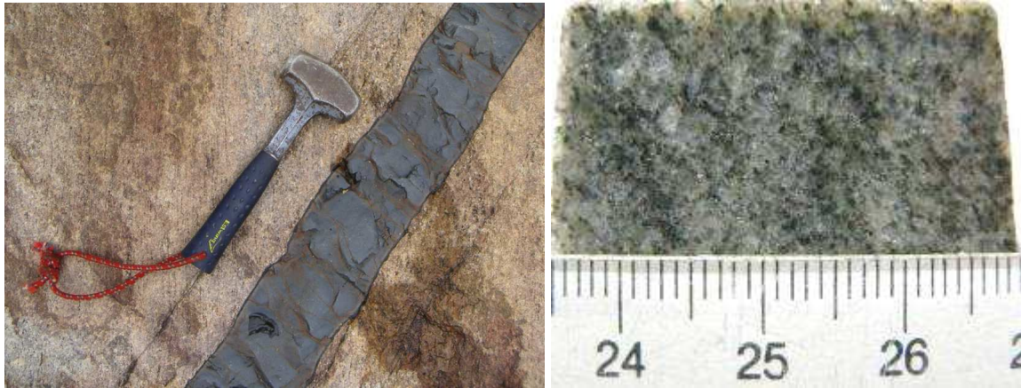
Figure 2.6 : (a) à gauche, dyke de basalte avec marges trempées sécant sur la foliation dominante , région Ampandrandava ( x=324993 m, y=229715 m), (b) à droite, dyke de microgranite au Nord – Est Ihasy ( x=381128 m, y=463749 m).
