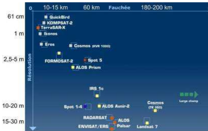
Figure 4.2 : Comparaison des capacités (résolution versus surface analysée par capteur) de différents satellites de cartographie géologique ( http://www.spotimage.fr/ )
